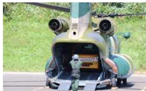
大型ヘリコプター（CH-47J）へ空輸対応型低圧応急用電源車「灯（ともす）」積載状況
